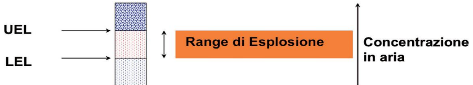
Figura 2: Range di esplosione
